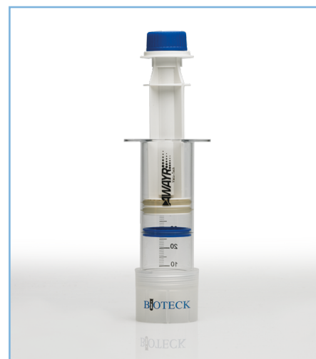
Fig. 1 – Il perfusore Awyr. Partendo dal basso si può osservare il tappo all'interno del quale trova alloggiamento l'attacco luer-lock, il corpo siringa con il setto mobile di colore blu a delimitare la zona in cui inserire il biomateriale (camera di perfusione), il pistone sollevato e, in cima ad esso, la valvola che permette di mantenere il sistema aperto o chiuso.
